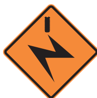
PROXIMIDAD DE CABLES DE ALTA TENSIÓN PTE - 4
