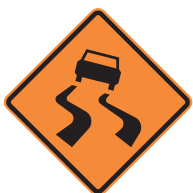
PAVIMENTO RESBALADIZO PTE - 2
