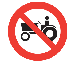
PROHIBIDA CIRCULACIÓN DE MAQUINARIA AGRÍCOLA RPO - 10
